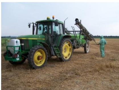
*Monté à l'avant du tracteur, Lavotop pulvé permet un nettoyage au champ à haute pression*
